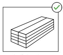
a. As lâminas devem ser armazenadas sobre uma superfície plana, garantindo apoio em todo o seu comprimento.
