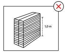
c. O empilhamento das lâminas não deve ultrapassar a altura máxima de 1,0 metro, a fim de evitar esmagamento da lâmina e acidentes.
